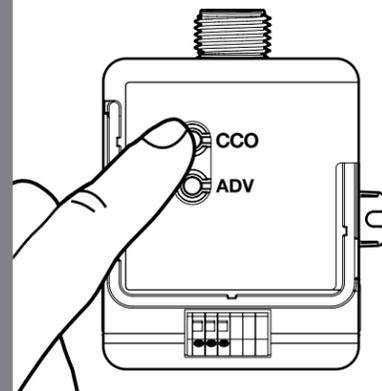
注:各手順が完了すると完了状態を示すため、CCOモジュールの接点が開閉します。
